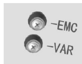
Схема ограничительных винтов для шасси с железным корпусом
