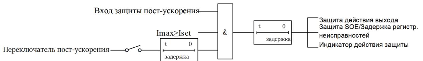
Рисунок 3-7 Логическая схема защиты пост-ускорения
