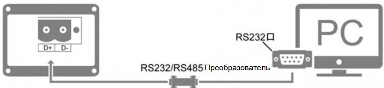
Рисунок 3-32 Схема подключения порта RS-485
