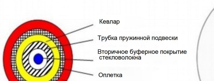
Рисунок 5.1.1 Эскиз структуры чувствительного к температуре волоконно-оптического кабеля
