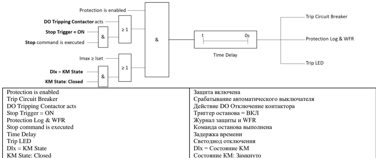
**Рисунок 4-15 Логическая схема защиты от отказа Контактора**
