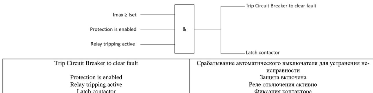
**Рисунок 3-18 Логическая схема защиты контактора**
