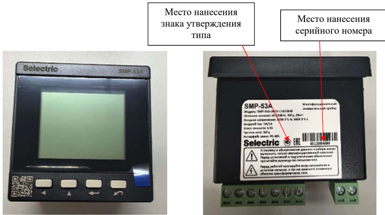
Рисунок 3 – Общий вид приборов модификации SMP-53A (форм-фактор LM72) с указанием места нанесения знака утверждения типа, места нанесения серийного номера
